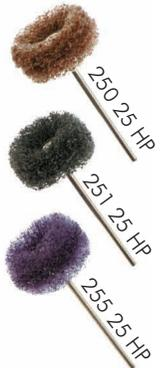
Non utilizzare durante la lavorazione un numero di giri troppo elevato. I migliori risultati si ottengono con un numero di giri di 5.000 /min-1 e con una pressione leggera; si evita così un eccessivo riscaldamento della resina.
