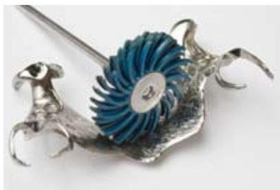
Con i dischi blu HABRAS Pro a grana fine (art. nr. 903 25(3) HP) si è semplificato notevolmente il processo di prelucidatura della placca palatale con superficie irregolare. Ad un numero di giri di 5.000 rpm, ogni singola setola del disco HABRAS Pro aderisce alle asperità della superficie.
