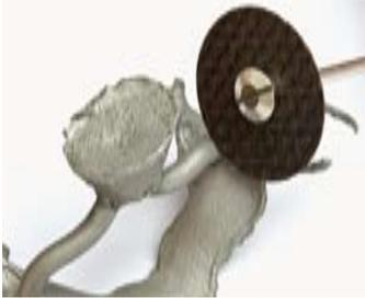
Dopo il raffreddamento, rimuovere la muffola con attenzione, utilizzando l'apposita pinza. I residui rimasti sulla superficie si eliminano con la sabbiatrice. Separare ora i canali di fusione e levigare con dischi separatori abrasivi.
