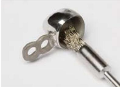
Si eliminano dalla superficie interna delle corone conimetriche in leghe CrCoMo eventuali perle di fusione con un pennello mini in filo d'acciaio ondulato (art. 193 p8 HP) utilizzabile poi per satinarne la superficie. I pennelli mini si utilizzano sempre con un numero di giri tra i 5.000 - 10.000 rpm.
