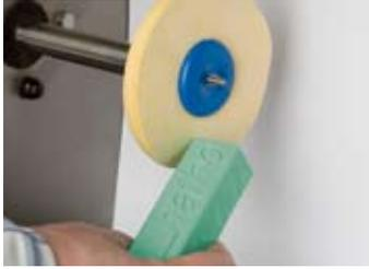
La superficie metallica è ora pronta per la lucidatura a specchio, si consiglia di utilizzare per questo tipo di lavorazione un disco multistrato in microfibra a 1.400 rpm. I migliori risultati su leghe CrCoMo si ottengono usando la pasta per lucidare Polistar verde. La microfibra morbida del disco assorbe in modo soddisfacente la pasta per lucidare, rilasciandola poi lentamente durante il processo di lucidatura.
