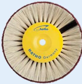
HATHO cepillo de entretelas con 2 hileras de cerda de Chung King Blanca y 2 entretelas de Scotch Brite™. ø 80 mm, con el centro de plástico HATHO Unfix por un mejor centraje y fijación. Adecuado para 3.500 min<sup>-1</sup>.
